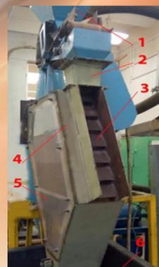
Из опыта исследований, пневматический каскадный классификатор имеет значение критерия Эдера-Майера 66 % при расходных концентрациях от 1,5 до 2,2 кг/м<sup>3</sup>.
