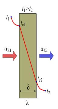
Схема теплопередачи через плоскую однородную стенку:
