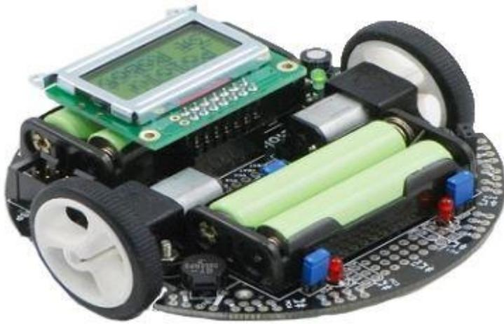
Мобильный робот-тележка осуществляет криволинейное движение за счет разности угловых скоростей ведущих колес, которые вращаются при помощи моторов-редукторов.
